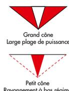
Les radiants INFRACONIC® possèdent 2 surfaces de rayonnement constituées de 2 cônes concentriques, c'est à dire de 2 radiants en un seul.
